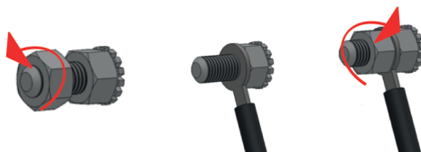
Figure 22. Connexion de l'appareil au dispositif équipotentiel.
