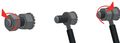
Obrázok 21. ripojenie zariadenia k systému vyrovnávania elektrického potenciálu.
