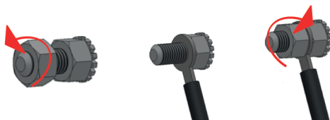
Obrázek č 22. Připojení přístroje k zařízení pro vyrovnávání potenciálu.
